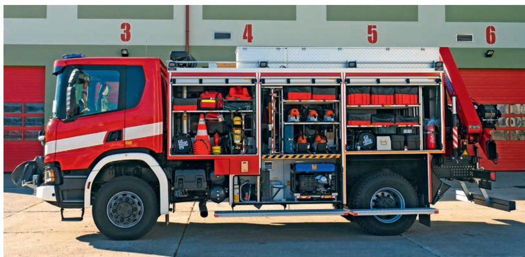
Fot. 5. W dolnej środkowej skrytce po lewej stronie zabudowy przewożony jest przenośny agregat prądowłórczy Eisemann H 7500 o mocy 6,5 kVA
