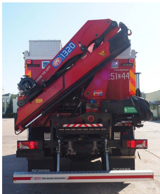
Fot. 13. W tylnej części samochodu umieszczony został żuraw hydrauliczny duńskiego producenta HMF model HMF 1320-K1-RCS
