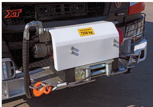
Fot. 3. Z przodu pojazdu zamontowano hydrauliczną wyciągarkę linową Powerwinch PWH 16 PRO o sile uciągu 7358 kg i stalowej linie o dł. 40 metrów
