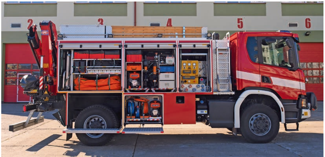
Fot. 7. Dwie boczne środkowe skrytki od dołu zamykane są klapami otwieranymi do dołu, które stanowią zarazem podesty robocze umożliwiające łatwy dostęp do sprzętu umieszczonego na górnych półkach
