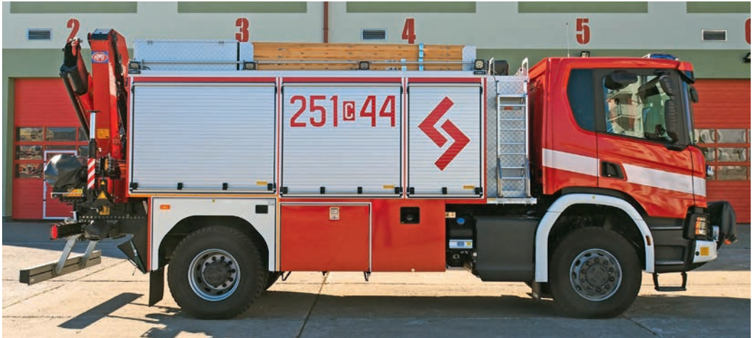
Fot. 6. Po prawej stronie zamontowano stalowy zbiornik paliwa o pojemności 200 litrów, natomiast zbiornik AdBlue ma pojemność 47 litrów
