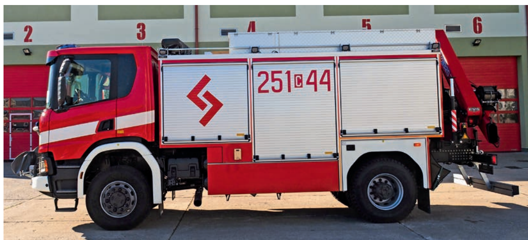
Fot. 4. Nadwozie pożarnicze pojazdu to konstrukcja klasyczna stalowo-aluminiowa. Posiada ona sześć skrytek sprzętowych – po trzy z każdego boku
