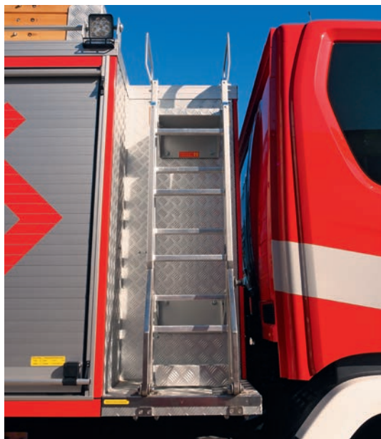
Fot. 9. Wejście na dach umożliwia rozkładana drabinka aluminiowa zamontowana na stałe po prawej stronie z boku za kabiną
