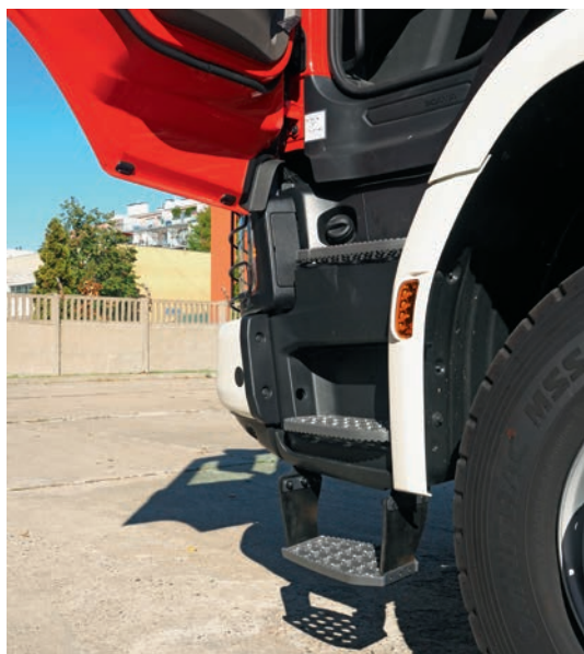
Fot. 2. Wejście do kabiny zapewniają trzy stopnie wejściowe, w tym pierwszy z nich, elastycznie zawieszony znajduje się na wysokości 250 mm
