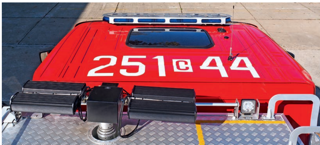
Fot. 8. W przedniej skrytce po lewej stronie zamontowano wysuwany pneumatycznie maszt oświetleniowy typu SVEP MPN-03-WPM
