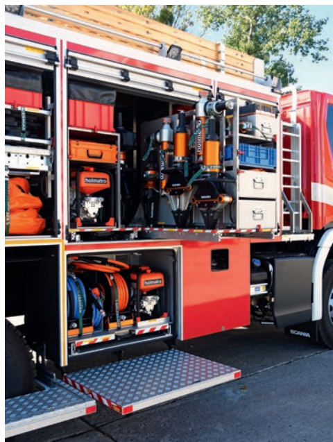
Fot. 12. Samochód z uwagi na swoje przeznaczenie posiada niezwykle bogaty zestaw hydraulicznych narzędzi ratowniczych Holmatro
