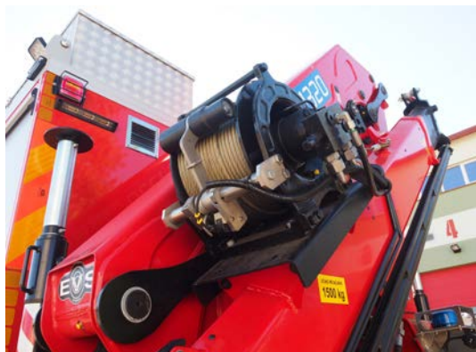
Fot. 14. Na głównym ramieniu żurawia, dodatkowo zamontowano wciągarkę hydrauliczną model P9E, o maksymalnym udźwigu 1500 kg
